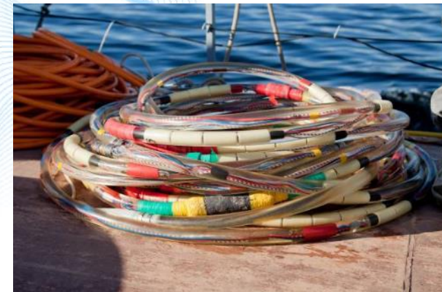
Сейсмическая коса (пьезоэлектрические приёмники)
