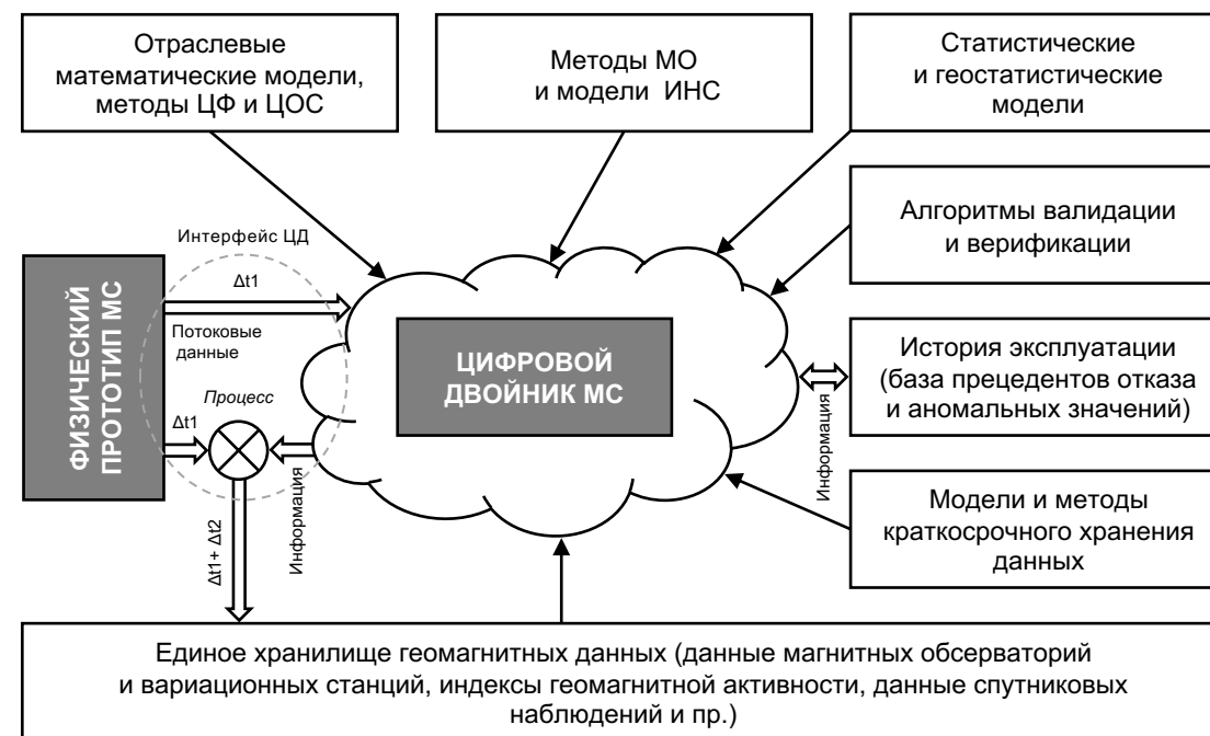
Рис. 9. Концептуальная модель цифрового двойника-экземпляра магнитной станции (МС – магнитная станция; ЦОС – цифровая обработка сигнала; ЦФ – цифровая фильтрация; МО – машинное обучение; ИНС – искусственная нейронная сеть; \Delta t_1 – время между реальным установлением параметра и фактической передачей его значения в виде потоковых данных; \Delta t_2 – время, затраченное ЦД на синтез соответствующего параметра и принятие решения о его регистрации)
